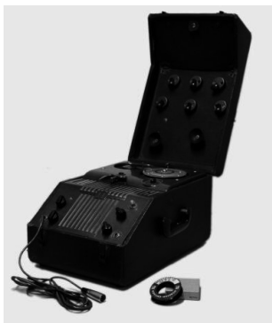
图4 杨荫浏录制阿炳遗音的钢丝录音机、钢丝录音带(1956)
