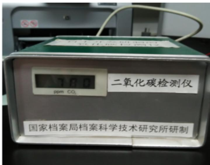
图 11 之前研制开发的二氧化碳检测仪
